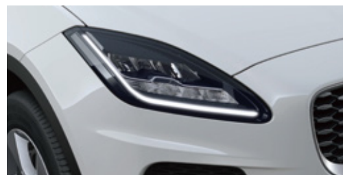
LEDヘッドライト (シグネチャー-DRL、リアアニメーションターンランプ付)
