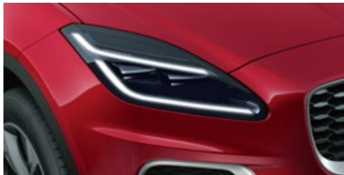
プレミアムLEDヘッドライト (シグネチャーDRL、フロント&リアアニメーションターンランプ付)
