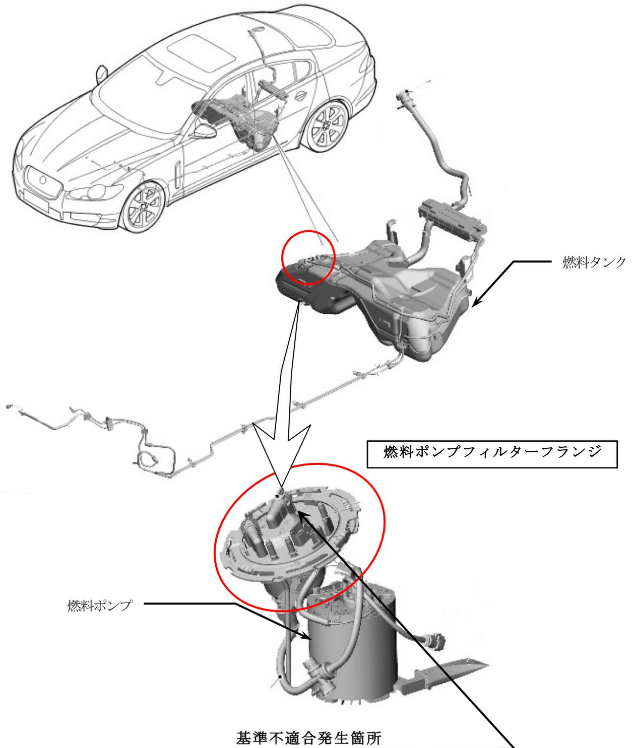
燃料装置において、燃料ポンプフィルターフランジの燃料圧力に対する強度が不足のため、フランジ部に亀裂が発生することがある。そのため、亀裂部から燃料が漏れ、漏れて気化した燃料が高温の排気管により着火し、最悪の場合、火災に至るおそれがある。
