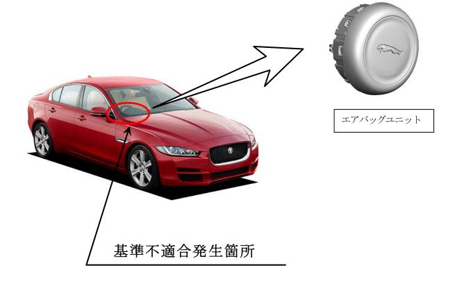
運転席用エアバッグのインフレータ(膨張装置)において、ガス発生剤の吸湿防止が不適切であった場合、高い湿度の環境下で温度変化を繰り返すと、ガス発生剤が劣化することがある。そのため、エアバッグ展開時にインフレータ容器が破損するおそれがある。
