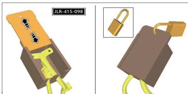
15. 直流 / 直流 (DC/DC) コンバータ コネクタの接続を外す。
