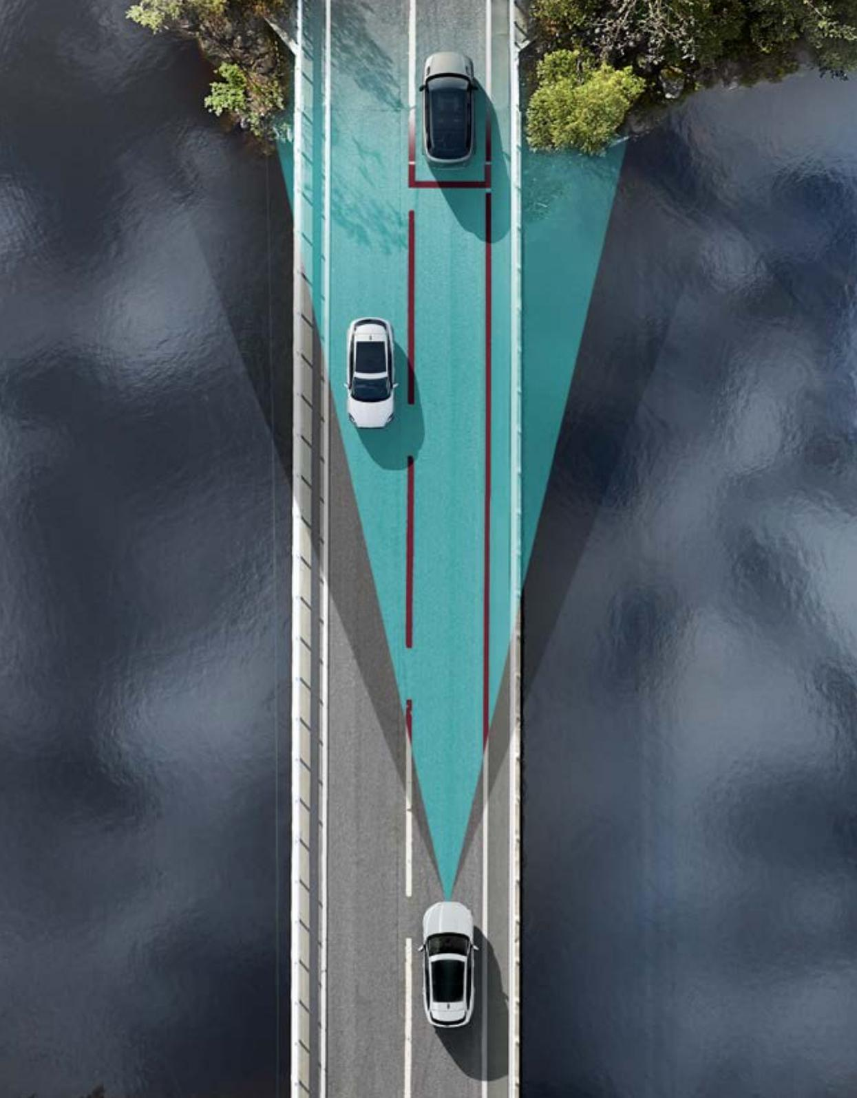
アダプティブクルーズコントロール(ステアリングアシスト付)は、先行車との車間距離を保ちながらステアリング、ブレーキ、アクセル操作などを自動的に調整し、ドライバーの運転負担を軽減する機能です。カメラとレーダーが連動して先行車や走行車線との距離を測定し、車両をレーン中央に維持しながら、先行車に合わせて減速、停止します。混雑した道路状況でも、リラックスしてドライブをお楽しみいただけます。
