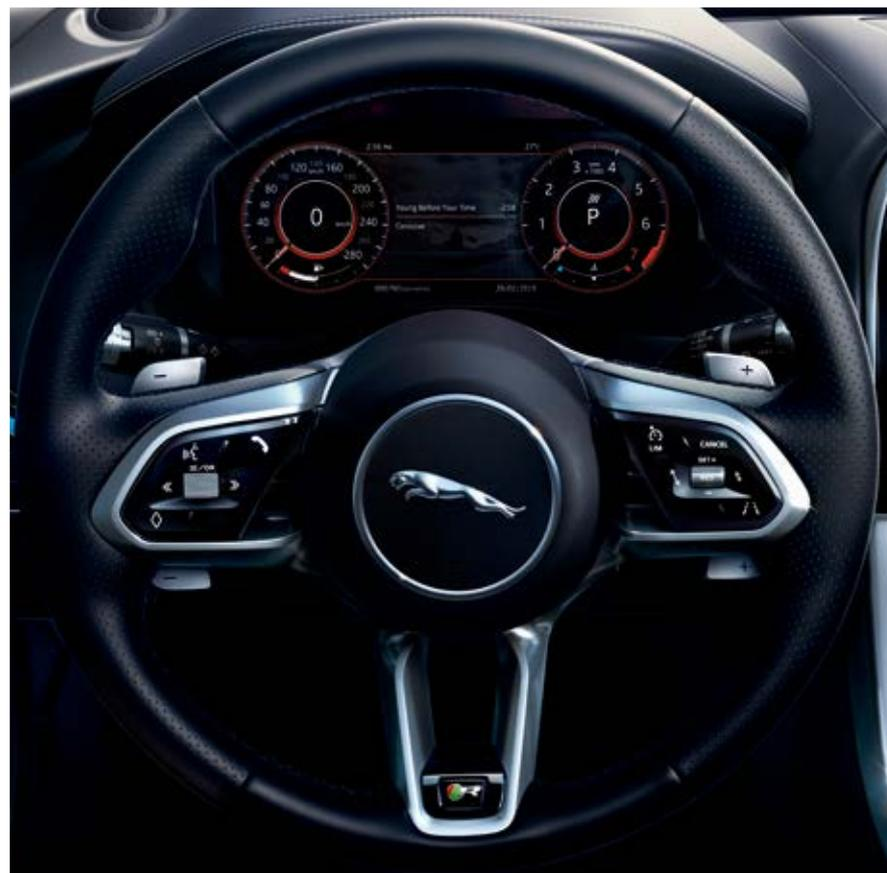
JaguarDriveコントロールでは「コンフォート」「エコ」「ダイナミック」「雨/氷/雪」のモードを選べます。各モードには専用のプログラムが設定され、エンジンとトランスミッションのレスポンス、ステアリングホイール、トラクション/スタビリティコントロールなどのパラメーターを最適化します。
